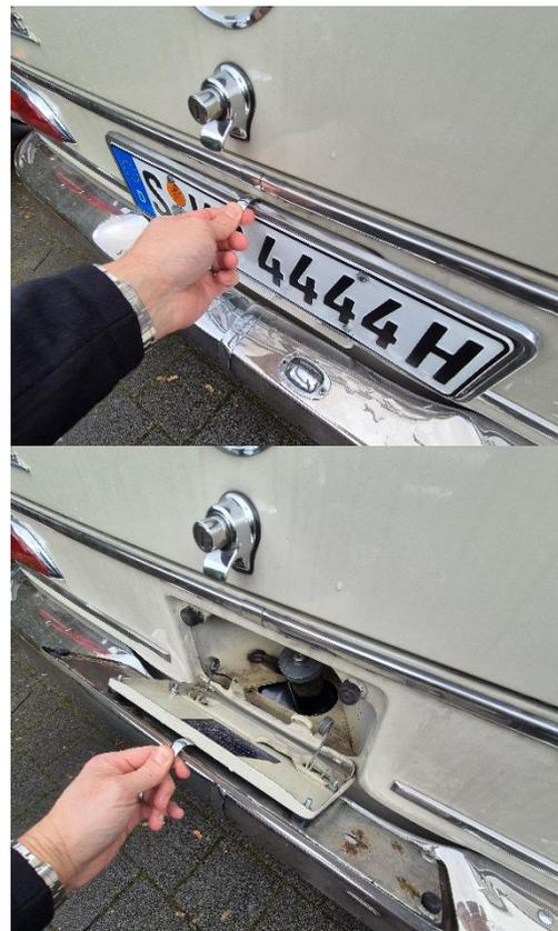
**Türen von außen öffnen** mit Schlüssel 2 (der kleine, eckige). Den Schlüssel einführen, Knopf um ca. 5 mm reindrücken und drehen, gegen den Uhrzeiger-Sinn wird die Tür entriegelt, im Uhrzeiger-Sinn schließt die Tür.
